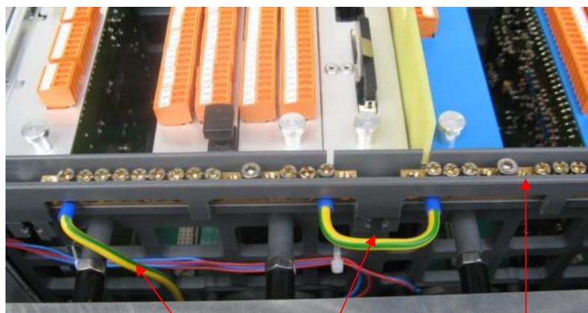
Verbindungsleitern der Schirmklemmen und Gehäuseanschluss
