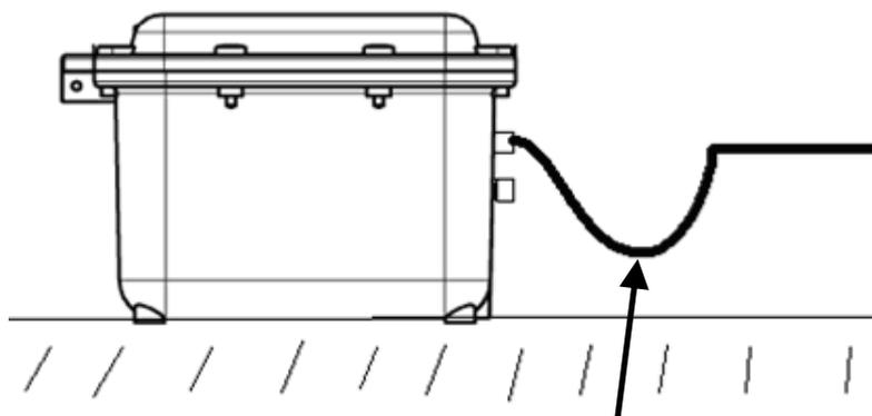
Verlegen Sie die Kabel so, dass vor der Kabeldurchführung eine „Wassersenke“ entsteht.
