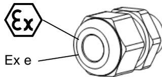
Kunststoff-Kabelverschraubung „Ex e IIC Gb“
