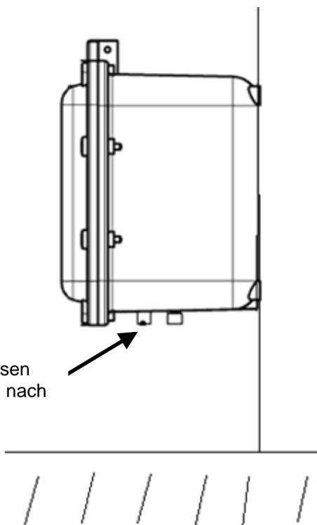
Bei vertikalem Einbau müssen die Kabelverschraubungen nach unten zeigen.
