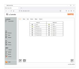
Im Menüpunkt "Ventile" können das am Ex p Steuergerät angeschlossene Spülgasventil eingestellt werden.
