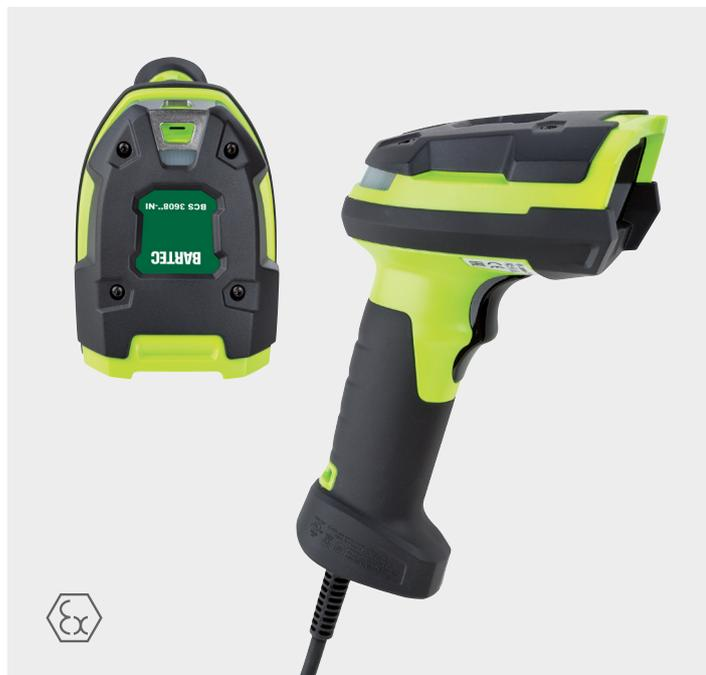
Die kabelgebundene Version ist ideal für stationäre Anwendungen zur Datenerfassung von 1D-Barcodes, 2D-Barcodes, Post Codes und OCR im explosionsgefährdeten Bereich. Die robuste Ausführung bietet alle hochentwickelten ergonomischen und funktionellen Merkmale, die in industriellen Anwendungen gefragt sind. Die kabelgebundene Version benötigt ein Universal-Versorgungsmodul um eine Ex-konforme Spannungsversorgung und Datenkommunikation zu gewährleisten.
