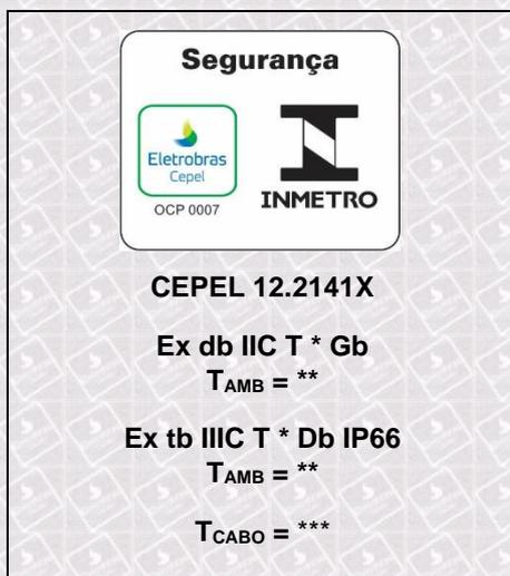
(\*) A marcação é complementada, com a indicação da classe de temperatura e a temperatura máxima de superfície relacionada à potência dissipada de acordo com a tabela 6.
