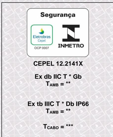
(\*) A marcação é complementada, com a indicação da classe de temperatura e a temperatura máxima de superfície relacionada à potência dissipada de acordo com a tabela 6.
