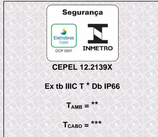
(\*) A marcação é complementada, com a indicação da classe de temperatura e a temperatura máxima de superfície relacionada à potência dissipada de acordo com a tabela 1.
