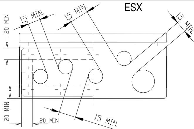
A entrada dos cabos deve ser realizada exclusivamente por meio de prensa-cabos, possivelmente equipados com um adaptador.
