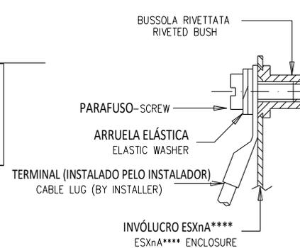
SCREW SUITABLE TO CLAMP A CABLE LUG FOR CABLE 4mm2
