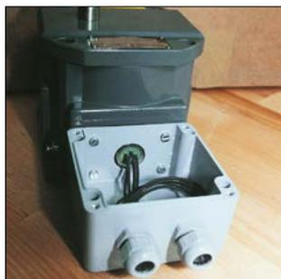
Aderleitungsdurchführung im Ex e-Klemmgehäuse
