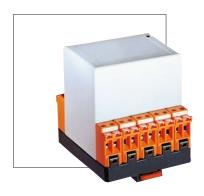
An den Trennschaltverstärker können 4 NAMUR Sensoren, Optokoppler, mechanische Kontakte oder andere Betätigungselemente eigensicher angeschlossen werden. Die eigensicheren Eingänge sind nach EN/IEC 60079-11sicher galvanisch von der Versorgungsspannung und den Ausgängen getrennt. Bruch und Schluss der Sensorleitungen wird erkannt und als Sammelstörmeldung über einen zusätzlichen Transistorausgang gemeldet. LEDs zeigen die Zustände der Ausgänge an.
