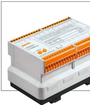
Das MODEX 8 x Relais out Modul kann über 8 Ausgänge in Ex e-Ausführung verschiedene Aktoren schalten. Es können zum Beispiel Magnetventile in Vergusskapselung, Leuchtmelder oder andere zugelassene Verbraucher bis 6 A direkt geschaltet werden. Das Modul wird über PROFIBUS-DP mit dem Prozessleitsystem verbunden. Für die Adressierung des Moduls stehen Codier-Drehschalter zur Verfügung.
