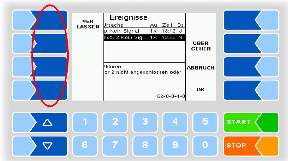
Um den Bildschirm EREIGNISSE zu verlassen, müssen Sie die verborgene Funktion VERLASSEN ansteuern, indem Sie einen beliebigen Softkey links drücken. Die Funktion VERLASSEN wird sichtbar und sollte zur Ansteuerung innerhalb von 3 Sekunden gedrückt werden.
