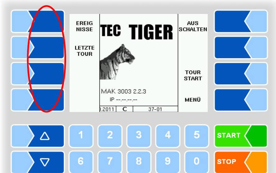
Um die verborgene Funktion EREIGNISSE anzuzeigen, drücken Sie einen beliebigen Softkey links. Die Funktion EREIGNISSE wird sichtbar und sollte zur Ansteuerung innerhalb von 3 Sekunden gedrückt werden, sonst erlischt sie wieder.
