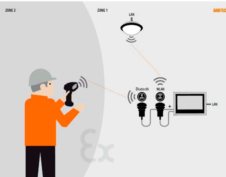
HMI System in Zone 1 mit Bluetooth Scanner Serie BCS3678-NI (Zone 2) und Verbindung zum Netzwerk via Wireless X AP.
