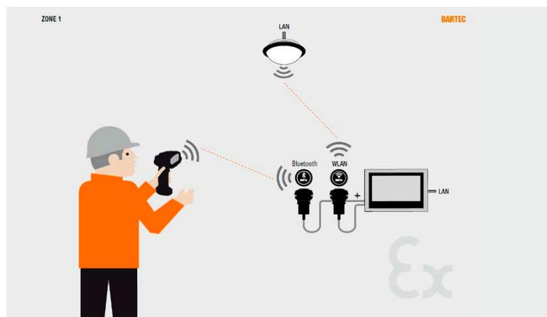
HMI System in Zone 1 mit Bluetooth Scanner Serie BCS3678-IS (Zone1) und Verbindung zum Netzwerk via Wireless X AP.
