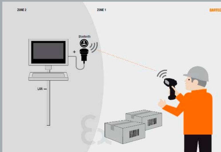
Use Case 3: Direkte Meldung ins Leitsystem in Zone 1 über BARTEC POLARIS Smart HMI 7" (stationär) und via Bluetooth angebundenen BCS
